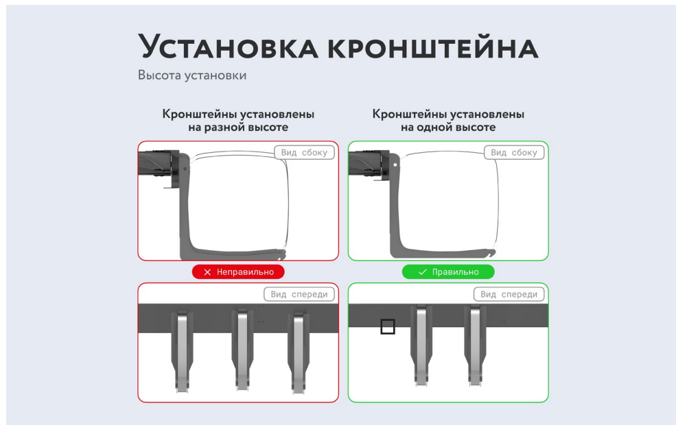
Рис. 1 — Схема установки кронштейнов на автомобиле
