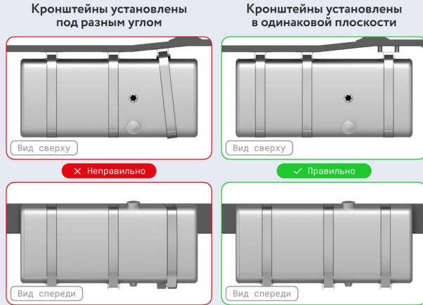
Рис. 2 — Схема установки кронштейнов на топливный бак
